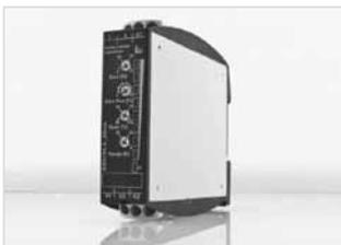
На вход устройства может быть подан сигнал переменного тока (AC) до 15A с помощью использования одного из трех диапазонов измерения. Устройство имеет масштабируемый выход, что позволяет оптимальным образом настроить преобразование сигнала к 4-20mA с помощью функции zero/span.
