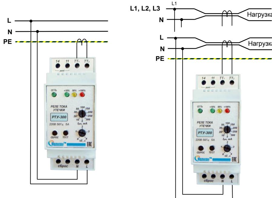
Крепление токового трансформатора
