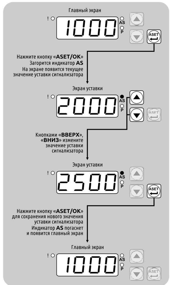
**Примечание 1:** Значение уставки сигнализатора может быть установлено в пределах диапазона измерения датчика ( $\epsilon P o L \dots \epsilon P o H$ ).
