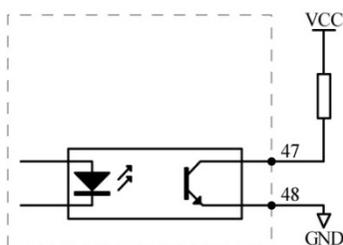
Рисунок 5-3 Импульсный выход
