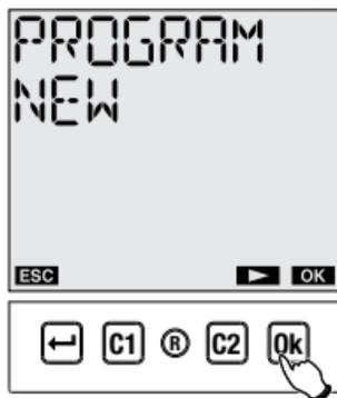
Выберите канал, для которого хотите создать программу, с помощью кнопок "C1" и "C2".
