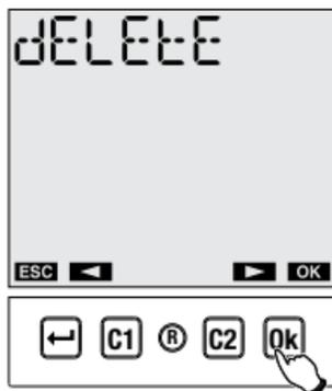
На дисплей будет выведено сообщение DELETE с последующим выводом номера канала (C1 или C2), таймер вернется в нормальный режим работы.
