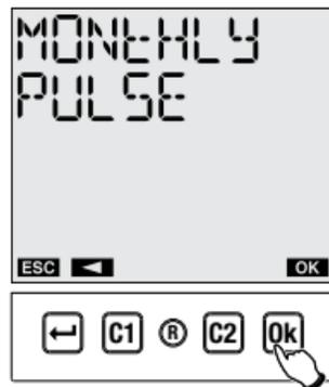
Используя кнопки "C1" и "C2" выберите тип импульса: ВКЛ-импульс или ВЫКЛ-импульс. Нажмите "Ok" для подтверждения.
