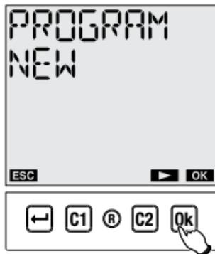
Выберите канал, для которого хотите создать программу, с помощью кнопок "C1" и "C2". Вы можете выбрать будет ли данная программа выполняться для канала 1, для канала 2 или для обоих каналов одновременно. Нажмите кнопку "Ok" для подтверждения.
