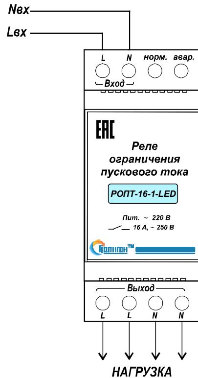
Рис.1. Типовая схема подключения РОПТ-16-1-LED.
