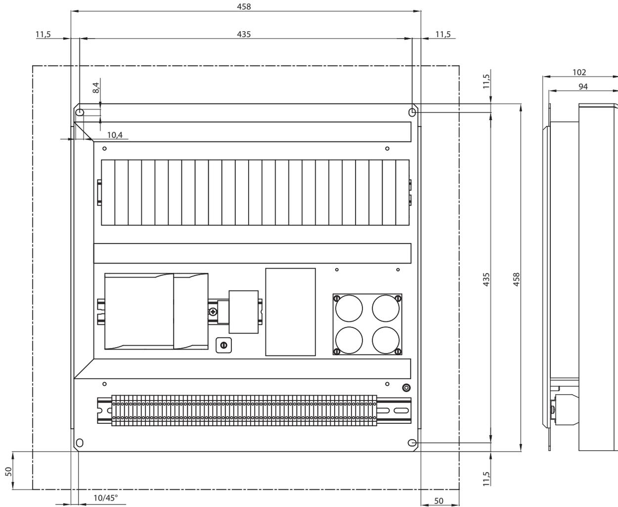
**План сверления для установки пластмассовой крышки**
