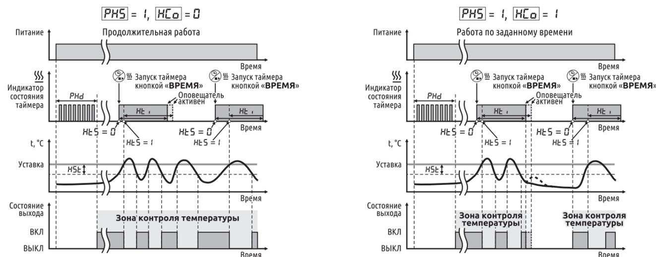
11.4  $[PHS=2]$  Регулятор и таймер управляется по сигналам с кнопки «ВРЕМЯ», расположенной на лицевой панели прибора, либо по сигналу с дискретного входа.
