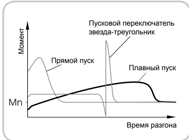
После подачи напряжения питания, TSG линейно увеличивает напряжение статора до достижения напряжения сети питания в течение заданного времени. Две оставшиеся фазы напрямую подключены к системе питания. Промежуток времени, в течение которого будет происходить этот процесс задается с помощью регулятора TON в диапазоне от 0 до 20 секунд. При увеличении напряжения увеличивается и момент вращения. Таким образом происходит запуск двигателя с постепенным разгоном.
