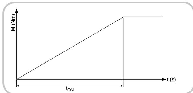
Если регулятор M<sub>ON</sub>, установлен в ненулевое значение, то при включении УПП напряжение (момент) подаваемое на двигатель быстро возрастет до заданного им значения. Только после этого начинается плавное увеличение напряжения, которое продолжается до достижения напряжения сети питания (100% LED ВКЛ) в течение оставшегося времени запуска. Такой способ запуска позволяет свести износ двигателя к минимуму.
